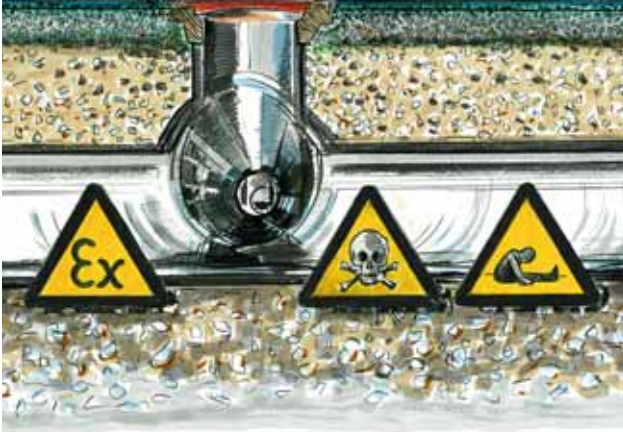
Fig. 1: il faut envisager les dangers suivants dans les puits, les fosses et les canalisations: explosion, intoxication, asphyxie.
