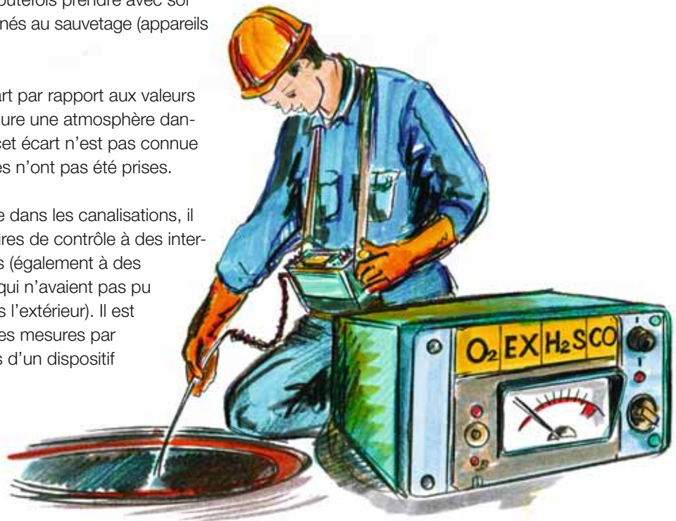
Fig. 7: avant de pénétrer dans des canalisations, il faut effectuer des mesures de contrôle: teneur en oxygène, gaz et vapeurs inflammables, hydrogène sulfuré, monoxyde de carbone.
