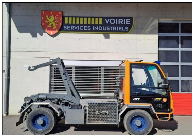
Service de la voirie : Véhicule multi lift Meili équipé d'une lame à neige, d'une saieuse, d'une grue et d'une citerne pour l'arrosage et haute pression
